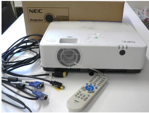
プロジェクター メーカー：NEC 明るさ：4000lm 入力端子：HDMI（映像音声） 15ピン（映像）
